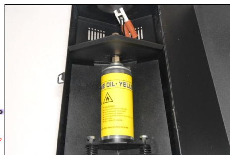
漏れが無いが確認する。
